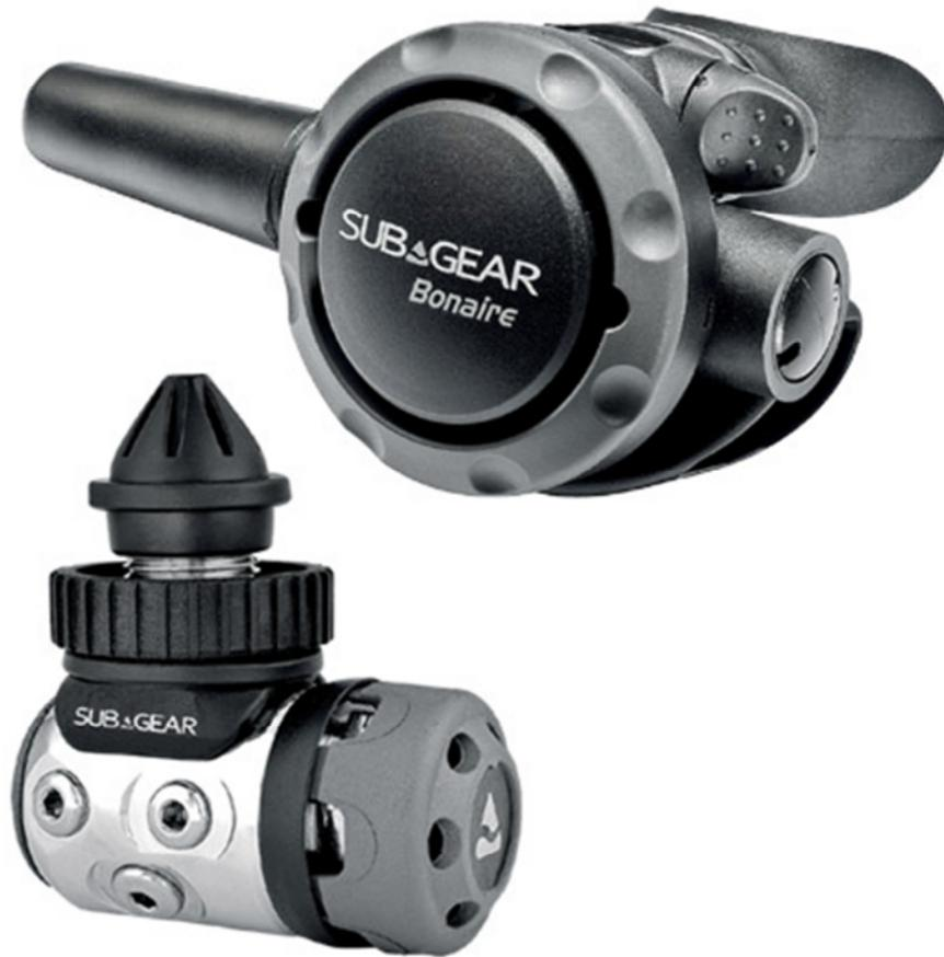
Der Atemregler BONAIRE ist mit seiner membrangesteuerten und kaltwasser-geprüften ersten Stufe ein echter Allrounder. Er garantiert eine hohe, zuverlässige Luftlieferleistung in allen Einsatzbereichen. Die extrem robuste Bauweise mit Trockenkammer in Kombination mit einem Downstream-Ventil in der zweiten Stufe, sichert höchsten Atemkomfort in jeder Situation. Der Schlauch an der zweiten Stufe kann wahlweise von rechts oder links angeschlossen werden.
